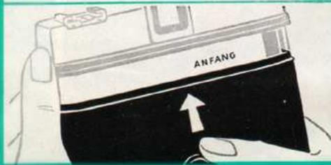
Die zugespitzte Papierlasche langsam in Richtung Leerspule ziehen und in längeren Schlitz der Leerspule einfädeln. Transportknopf in seiner Pfeilrichtung 2- bis 3mal drehen. Auf geraden Papierlauf achten.
