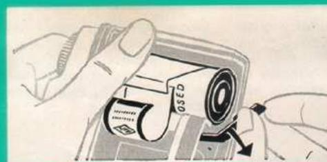
Oberen Spulhalter herausklappen. Dabei belichteten Film festhalten und aus der Camera nehmen. Papierende umknicken und mit anhängendem Klebestreifen zukleben. Film sofort lichtsicher verpacken.
