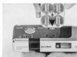
10 Blitzen: topflash aufstecken. Blitzbereich an \text{**} -Marke einstellen. Blitzzeit (1/2 sek.) und -Blende stellen sich automatisch ein.
