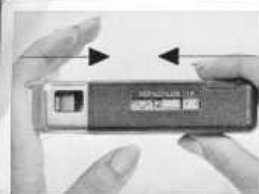
9 Replomatic – Schnelltransport: 1 x zusammenschieben – die Agfomatic ist sofort wieder aufnahmebereit.
