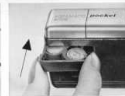
16 Batterien wechseln: Schutzfach herausziehen; zwei Batterien Varta 246, Varta 720 oder Mallory MN 625 G einsetzen (s. Abb.)
