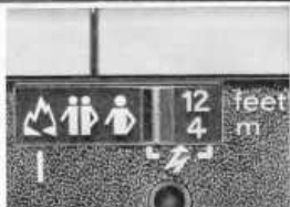
6 Entfernungseinstellung: \text{♠} = 1–2 m, \text{♣} = 2–5 m, \Delta = 5 m – \infty , Verschlusssteuerung elektronisch von 30 bis 1/500 sec.
