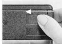
3 Schieber an der Unterseite nach links – Kamera springt auf, Objektiv und Sucher werden frei.
