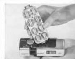
12 Nach vier Blitzaufnahmen: topflash umdrehen, vier weitere Lampen sind blitzbereit.
