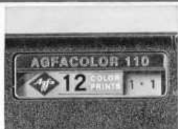
5 Filmtransport ist nun gesperrt. Kamera kann bis zur nächsten Auslösung beliebig oft zusammengesoben werden.
